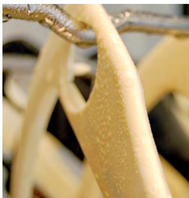
Bauteile in einer Klimaprüfkammer
