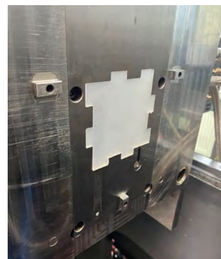
Geöffnetes Versuchswerkzeug: Spritzgegossene Thermoplast-Komponente wurde mit EPP hinterspritzt
