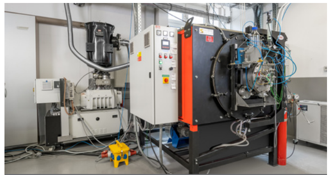
Abbildung 4: Reaktor der CVD 3 mit angeschlossenem Pumpenstand
