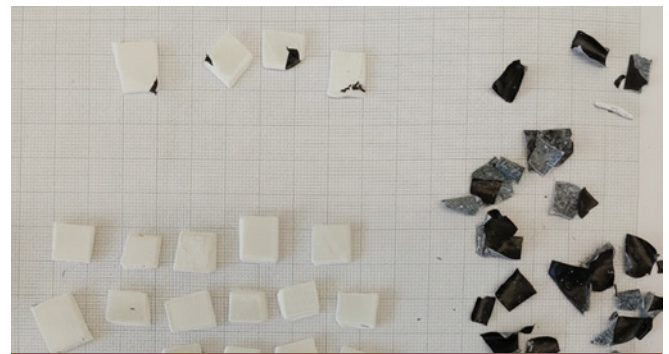
Abbildung 1: Zerleinerte und entschichtete PC-ABS Kunststoff-Flakes (links), entschichteter Lack (rechts) (DTNW)
