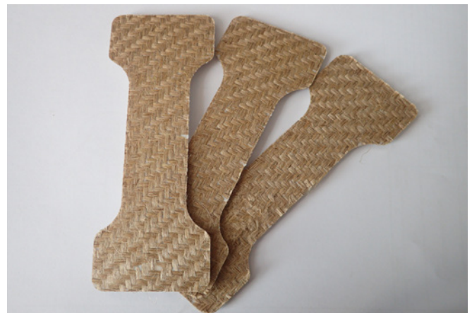
Abbildung 1: Naturfasergewebe mit Kunststoff hinterspritzt für Zugversuche
