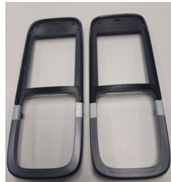
Abbildung 1: Formteile mit Auswaschung im silberfarbenen Bereich (links) und optimiert (rechts)
