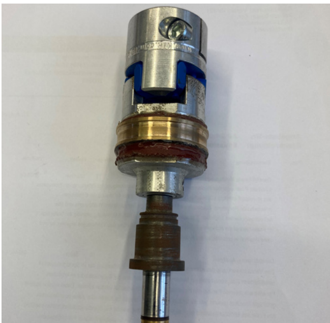
Abbildung 1: Autoklaven-Drehdurchführung für elektrochemische Herstellung von M(CO)_6
