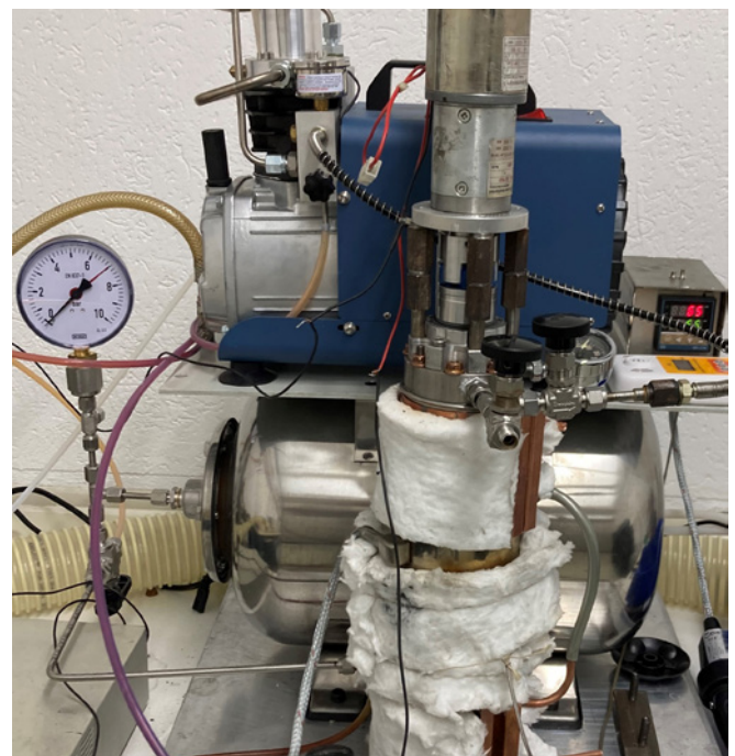
Abbildung 2: Precursorsynthese mittels Autoklaventechnik
