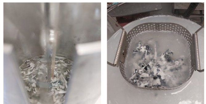
Abbildung 2: Zerleinerte und lackierte Kunststoff-Flakes in BBL im Laborreaktor (DTNW)
