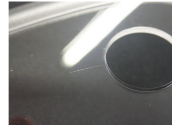
Bindenahtkerbe Unterseitig sichtbar
