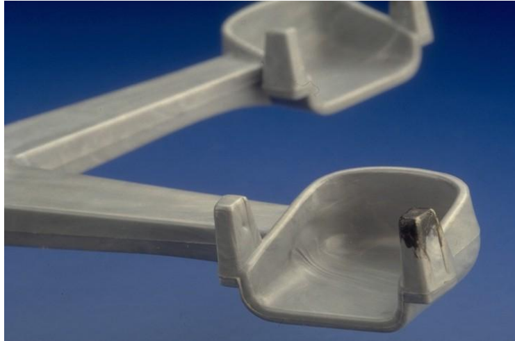
Diseleffekt an zuletzt gefüllten Formteilbereichen
