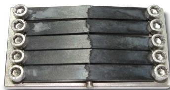
PA6.6-GF30 versagt bereits nach wenigen Stunden Kontakt mit \text{ZnCl}_2 -Lösung
