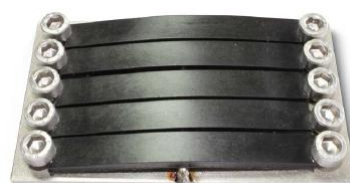
AKROMID® A3 GF 30 1 L zeigt selbst nach 200 h unter mech. Belastung einer \text{ZnCl}_2 -Lösung ausgesetzt, noch keine Schädigung
