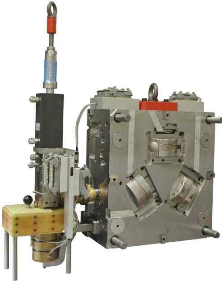
Werkzeug der Fa. Krallmann zur Herstellung der LED-Lampe
