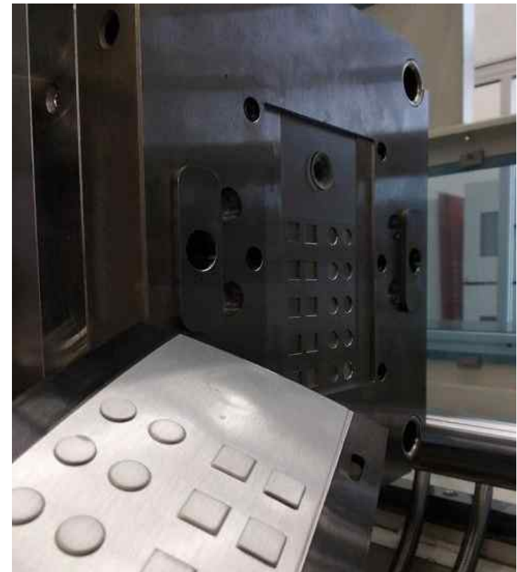
Versuchsgeometrie und -werkzeug zur Abformungsanalyse
