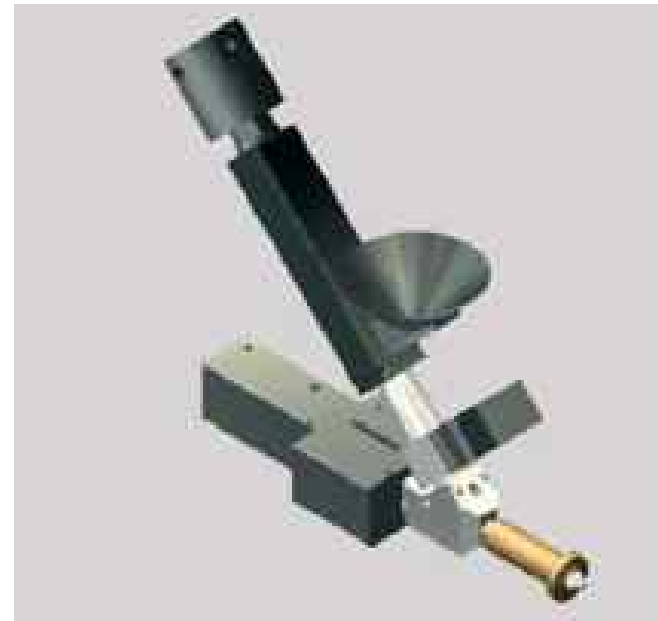
Spezielle Einspritzeinheit für niedrigschmelzende Metalllegierung
