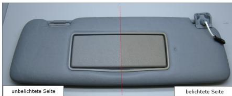
Artikel „Sonnenblende DB H2 - grau“ nach der Sonnenlichtsimulation DIN 75220-D-IN1-T (240 h)
