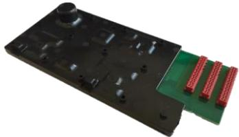
Umspritzte PCB mit 6 Schaltkreisen, die während des Spritzgießprozesses überwacht werden können; Kombination von verschiedenen elektronischen Bauteilen und Umhüllungs-materialien getestet
