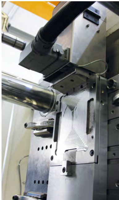
Metalldirekteinspritzaggregat auf Spritzgießwerkzeug
