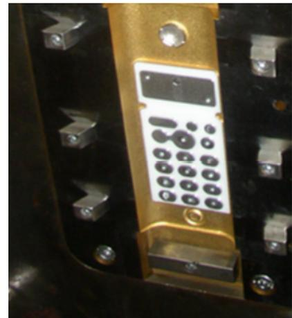
Abbildung 1: Werkzeugkavität mit keramischem Werkzeugeinsatz
