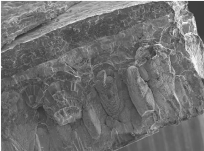
Abbildung 1: Bruchkante einer Multischicht
