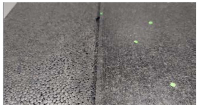
Abbildung 2: Möglichkeiten zur Oberflächenprägung mit 250 µm PC-Folie
