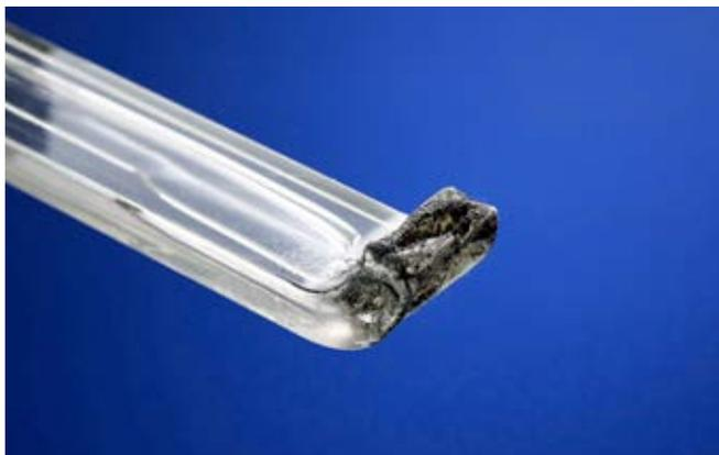
Abbildung 1: Dieseeffekt durch unzureichende Werkzeugentlüftung
