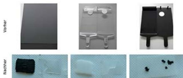
Abbildung: Beschichtete Bauteile vor und nach dem Entschichtungsprozess mit biobasierten Lösemitteln
