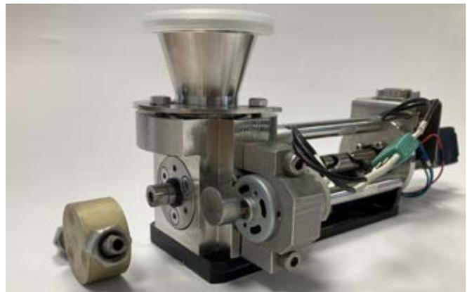
Abbildung 2: Einschneckenextruder; \*Patentierte Technologie: Deutschland, Europa; eingereicht: weltweit
