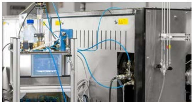
Abbildung 4: Steuerung der Precursor- und Gaszufuhr an der CVD 4
