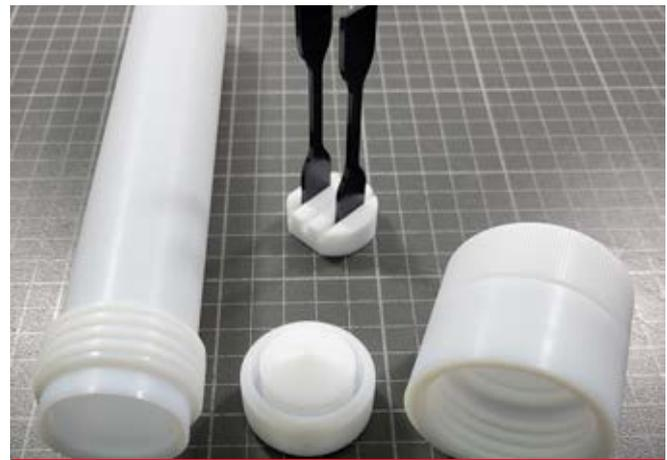
Abbildung 2: Autoklav und Probekörper
