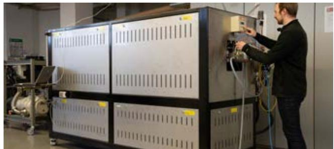
Abbildung 3: CVD 4 mit installierter Mikrowellen-Plasmaquelle
