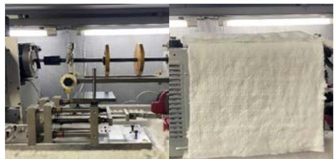
Abbildung 2: Reibprüfstand ohne und mit Heizhaube
