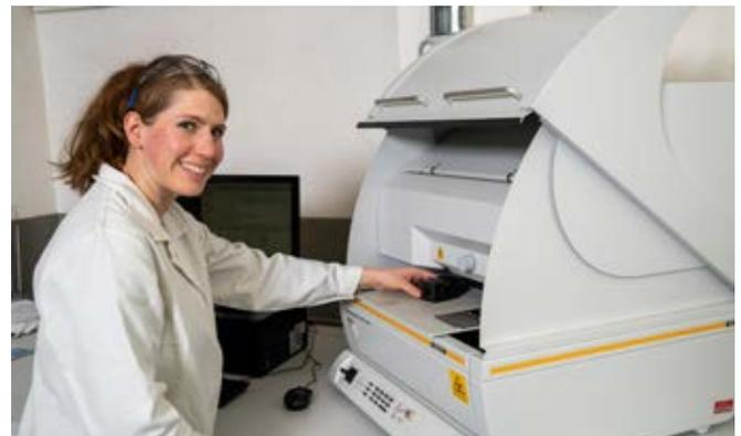
Abbildung 2: Röntgenfluoreszenzanalysegerät
