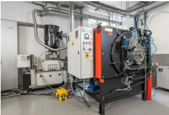
Abbildung 2: Reaktor der CVD 3 mit angeschlossenem Pumpenstand
