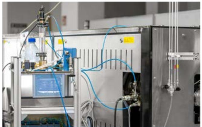
Abbildung 1: Feststoffzuführung in CVD-Prozess
