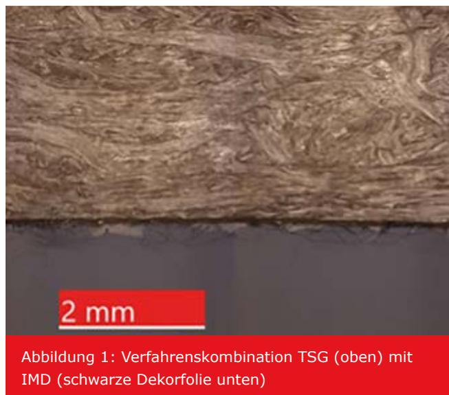
Abbildung 1: Verfahrenskombination TSG (oben) mit IMD (schwarze Dekorfolie unten)
