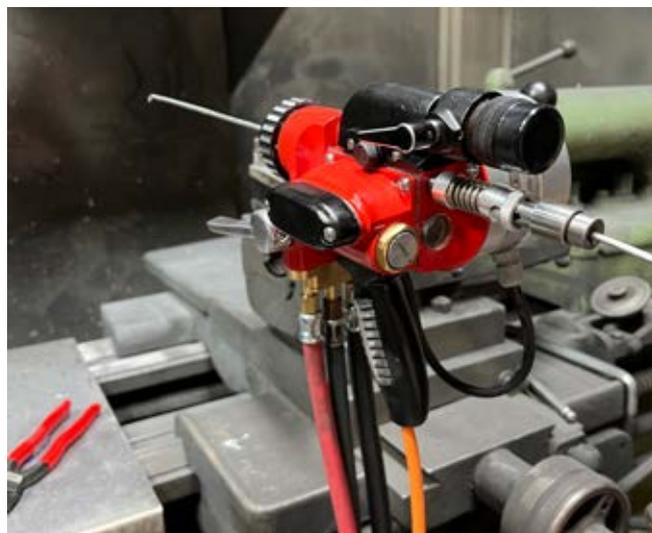
Abbildung 1: Modifizierte Flammspritzpistole zur Ausbringung einer Polyarylsulfonbeschichtung (Bräuer Oberflächentechnik GmbH)
