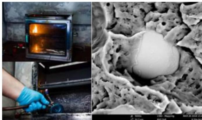
Abbildung 1: Brandprüfung nach UL 94/ Füllstoffpartikeln in Kunststoffmatrix
