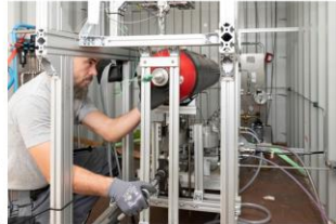
Anlage zum Befüllen der Wasserstoffspeicher Quelle: BAM
