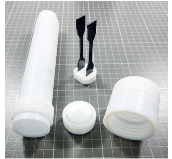
Autoklav zur Auslagerung von Materialproben im Elektrolyt
