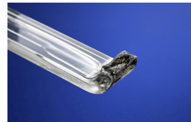
Abbildung 1: Dieseeffekt durch unzureichende Werkzeugentlüftung
