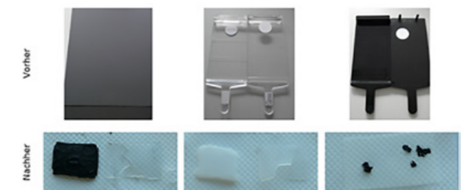
Abbildung: Beschichtete Bauteile vor und nach dem Entschichtungsprozess mit biobasierten Lösemitteln
