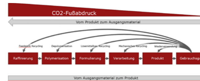
Abbildung 1: Kreislaufführung und die Auswirkungen auf den CO 2 -Fußabdruck
