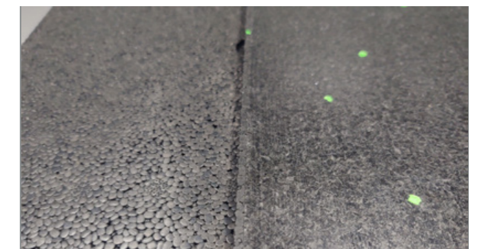
Abbildung 2: Möglichkeiten zur Oberflächenausprägung mit 250 µm PC-Folie
