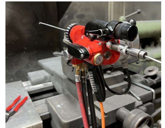
Abbildung 1: Modifizierte Flammstritzpistole zur Ausbringung einer Polyarylsulfonbeschichtung (Bräuer Oberflächentechnik GmbH)
