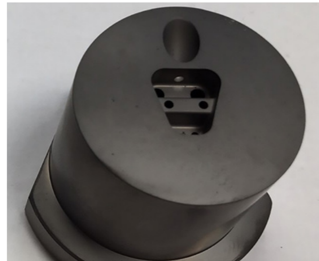
Abbildung 2: Formeinsatz für Metallspritzguss W_2C beschichtet in einem tiefliegenden Konturbereich mit anschließender Ausstoßerbohrung
