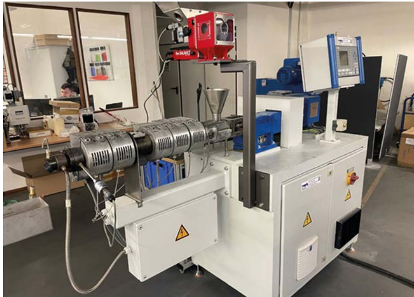
Doppelschnecken-Compoundieranlage im Einsatz
