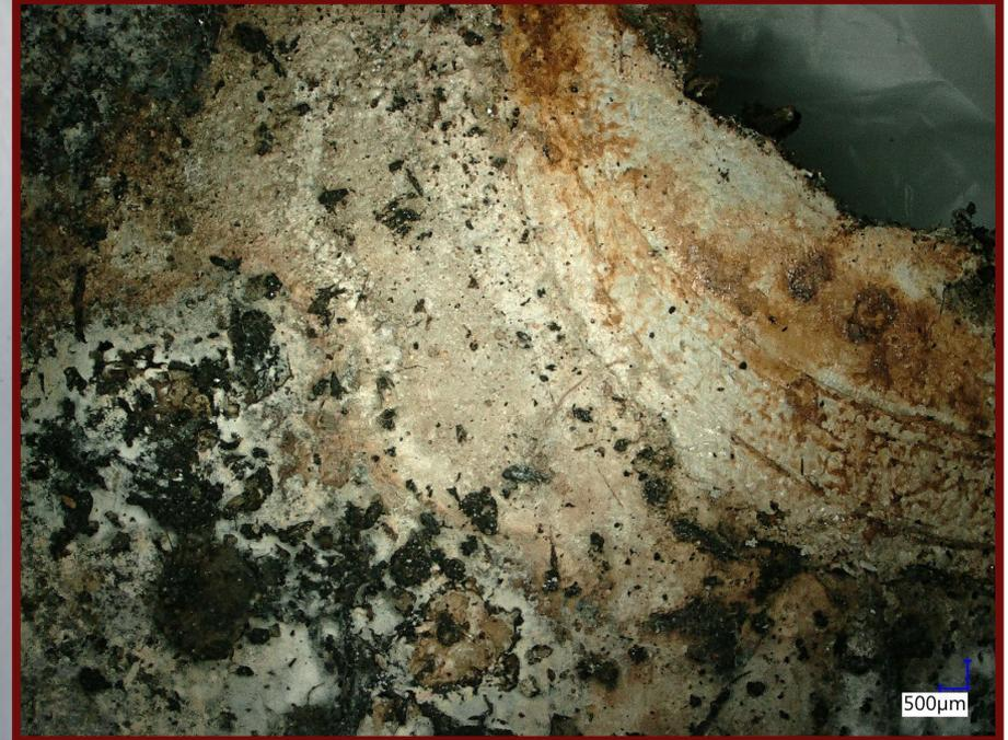
*Links:* Platte nach der Entnahme aus dem Kompost.
