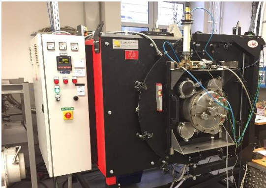
Der Reaktor der aktuell größten Beschichtungsanlage der KIMW-F hat einen Durchmesser von 540 mm und eine Länge von 1000 mm
