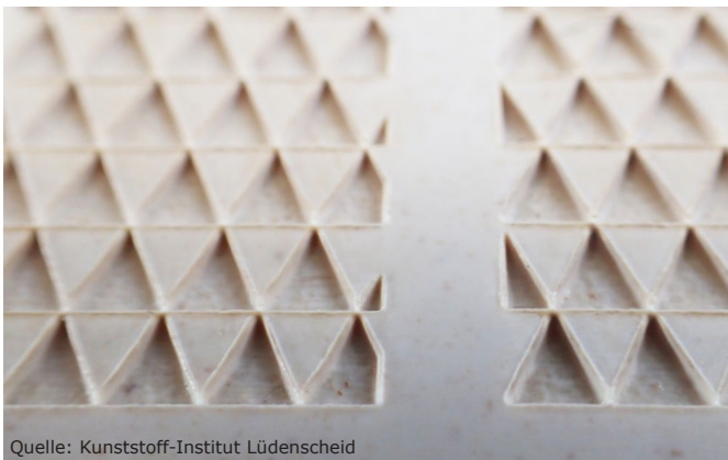
Vertiefte Strukturen durch Laserbehandlung
