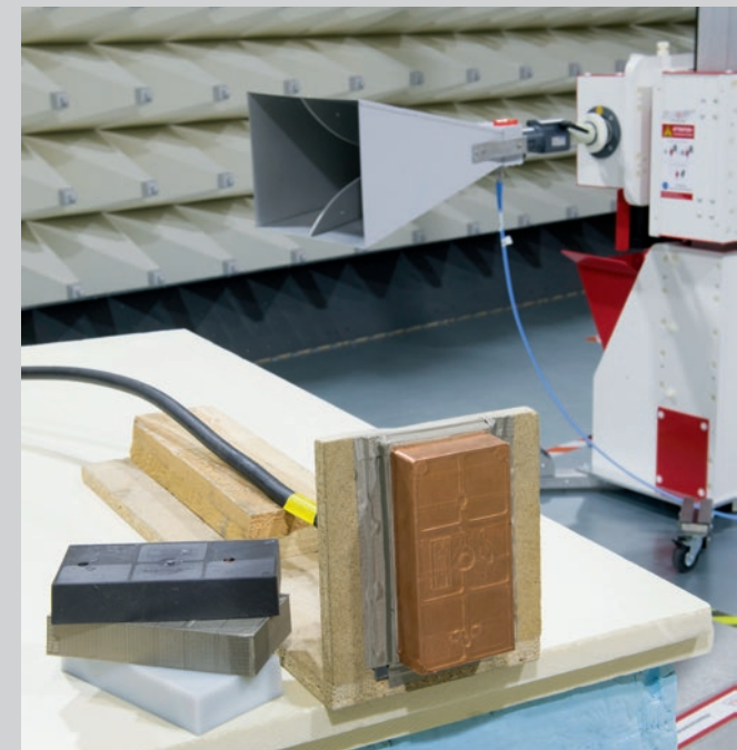
Gehäusemessung nach EN 61000-5-7 in Absorberhalle Quelle: EMC Test NRW GmbH, Dortmund
