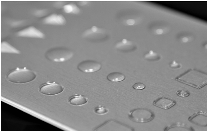
Beispiel einer Strukturplatte, Kombination FIM & IMC
