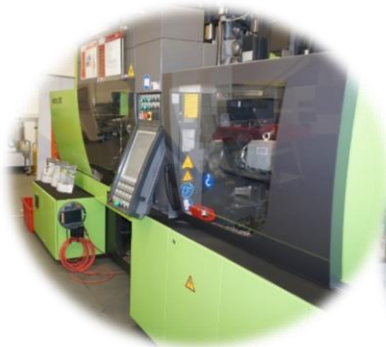
Spritzgießmaschine Engel VC330H/120 CO
