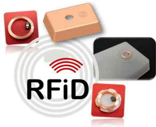
*RFID Tag, 3D Modell des Demonstrator Bauteils, gespritztes Bauteil mit integriertem RFID Tag, RFID Tag im Trägermodul (v.l.n.r.)*
