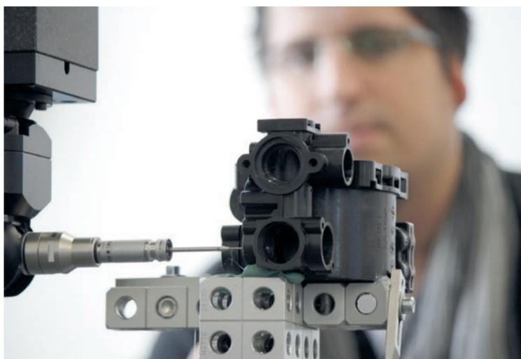
Taktile Messung eines Pumpengehäuses
