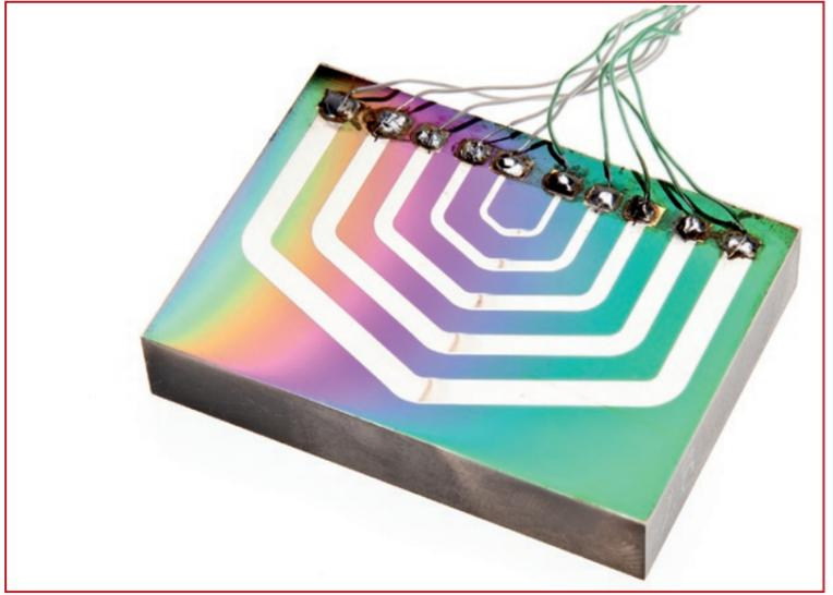
Bild 2: Mehrlagiges Schichtsystem des Dünnschichtthermoelements
