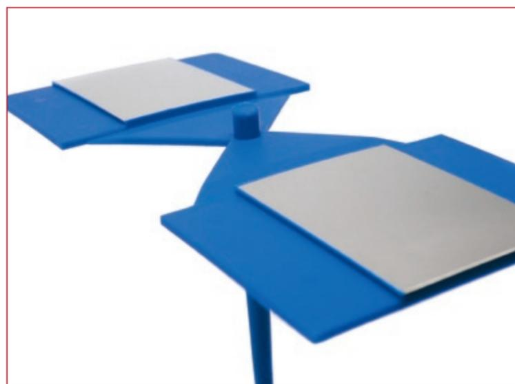
Hoch belastbare Kunststoff-Metall-Verbindung auf stoffschlüssiger Basis durch den Spritzgießprozess hergestellt [Quelle: Kunststoff-Institut Lüdenschied]
