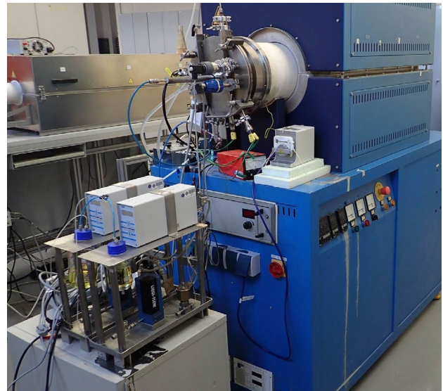
Abbildung 3: Reaktor und Peripherie der CVD 1, Einlassseite, Flüssigkeitsregler und Schlauchpumpe dienen der Dosierung der flüssigen Vorläuferverbindungen.
