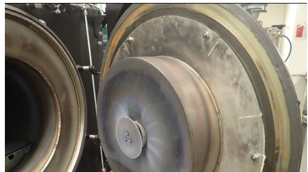
Abbildung 10: CVD 3, Fronttür von innen mit Gas- und Precursor-Injektion
