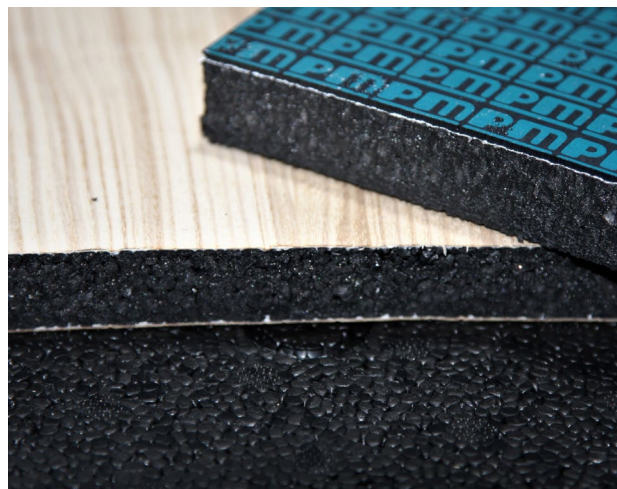
Abbildung: Ergebnisse des prozessintegrierten Dekorationsverfahrens von EPP-Bauteilen – Ein Vergleich der Oberflächen unbeschichtet schwarz, digitalbedruckte Folie und Holzfurnier Esche (beidseitig beschichtet)
