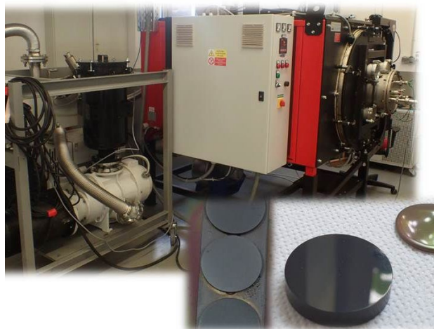
Abbildung: neu aufgebauter CVD Reaktor und mit TBC beschichtete Probekörper zur Analyse der Schichtperformance
