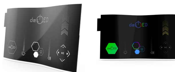
Abbildung 2: Projektdemonstrator mit integrierter OLED und Touchbedienung im Tagdesign (links) und Nachtdesign (rechts)
