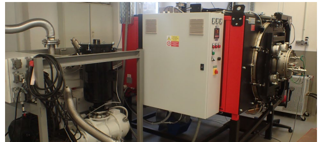
Abbildung 8: Reaktor der CVD 3 mit angeschlossenen Pumpenstand
