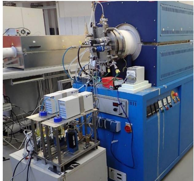
Abbildung 4: Reaktor und Peripherie der CVD 1, Einlassseite, Flüssigkeitsregler und Schlauchpumpe dienen der Dosierung der flüssigen Vorläuferverbindungen.
