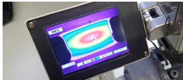
Abbildung 3: Temperaturverteilung durch das Werkzeug mit Wärmebildkamera
