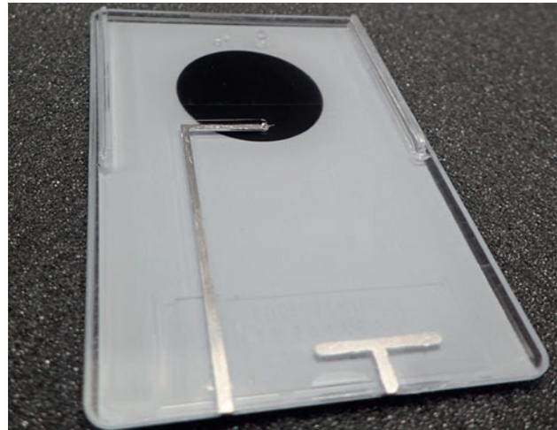
Abbildung 1: Kontaktierung eines kapazitiven Tasters
