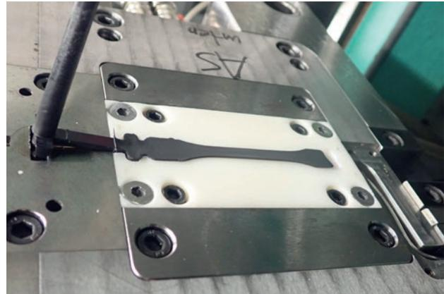
Abbildung: Dreidimensional gedruckter Formeinsatz zur Herstellung eines Prüfkörpers
