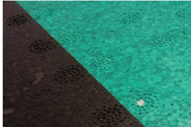
*Abbildung: Darstellung der charakteristische EPP-Oberfläche in zwei Farbvarianten. Eindeutig zu erkennen sind die für EPP charakteristischen Dampf-düsen-Abdrücke*
