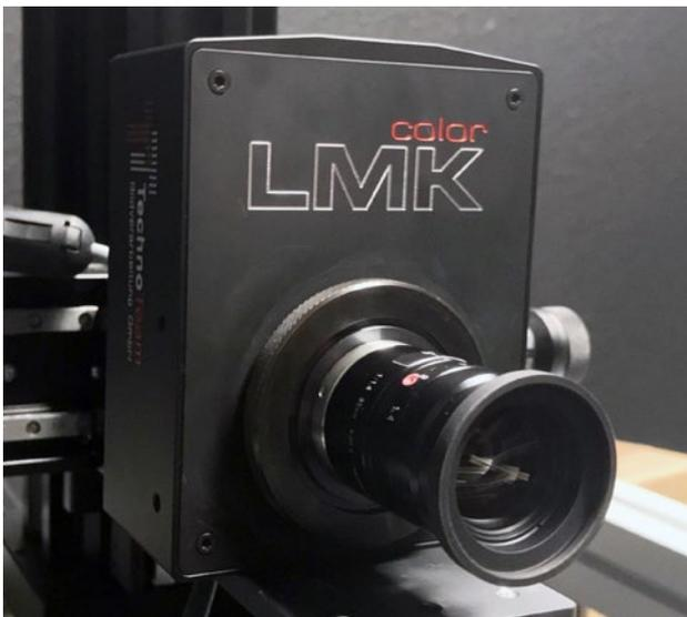
Abbildung 1: Leuchtdichtemesskamera LMK5-5 Color
