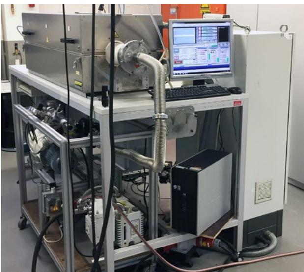
Abbildung 7: Reaktor und Peripherie der CVD 2
