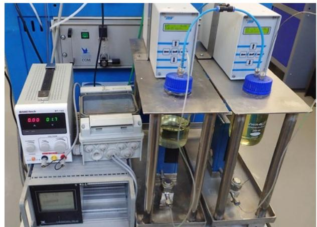
Abbildung 5: Flüssigkeitsregler inkl. Steuereinheit an der CVD 1
