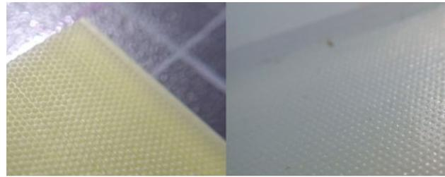
Abbildung 1: Oberflächenstruktur eines optischen Bauteils, generiert aus 3D-Daten (links); Silikonabformung (rechts)
