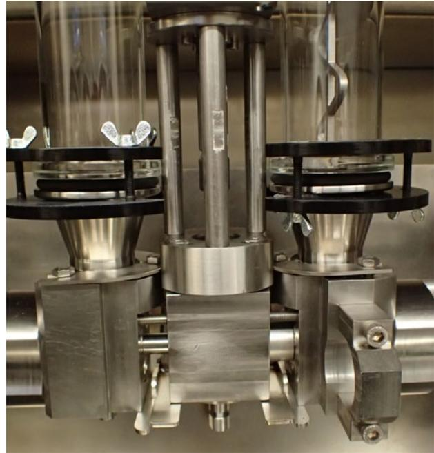
Abbildung 1 : Minireaktor mit 2-Komponenten Extruderzuförderung
