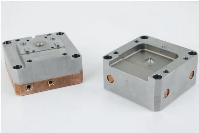
Abbildung 1: Hybrider Werkzeugkern aus dem Projekt HybridTemp.
