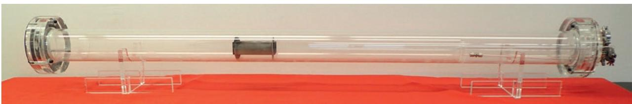
Abbildung 2: transparenter CVD Reaktor, mit Werkzeug in der Mitte des Reaktors.
