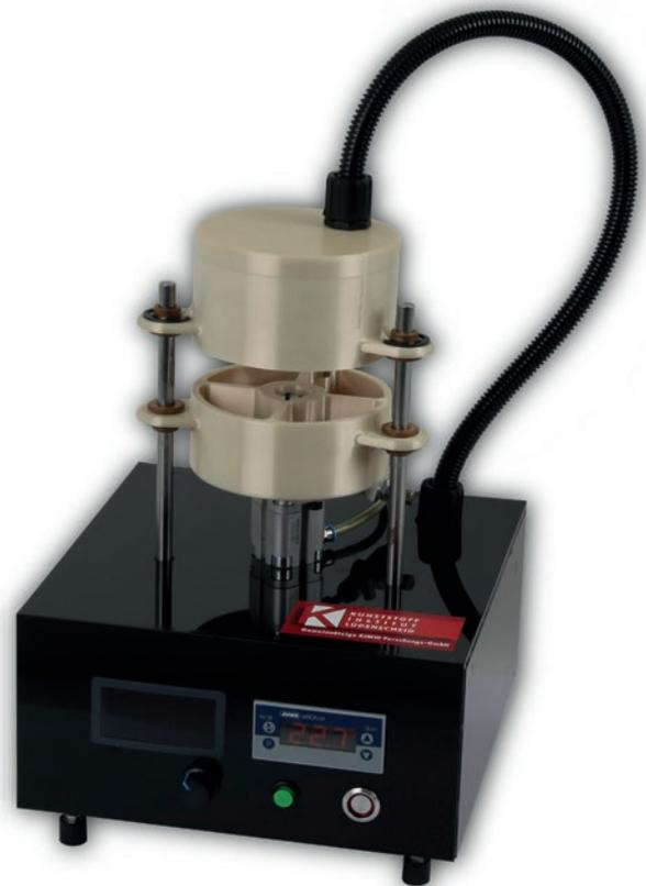
Abbildung 1. Der Wärmeleitprüfstand der gemeinnützigen KIMW Forschungs-GmbH.
