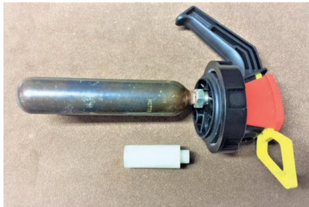
Abbildung 1: Im Feuerlöscherkopf eingebaute Druckkartusche aus Stahl im Vergleich mit dem entwickelten DGG mit Nitrocellulose-treibsatz.
