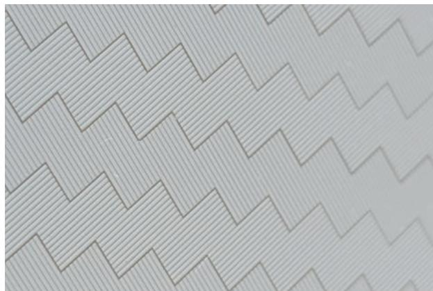
Abbildung 1: Formeinsatz mit laserstrukturierter Keramikbeschichtung.
