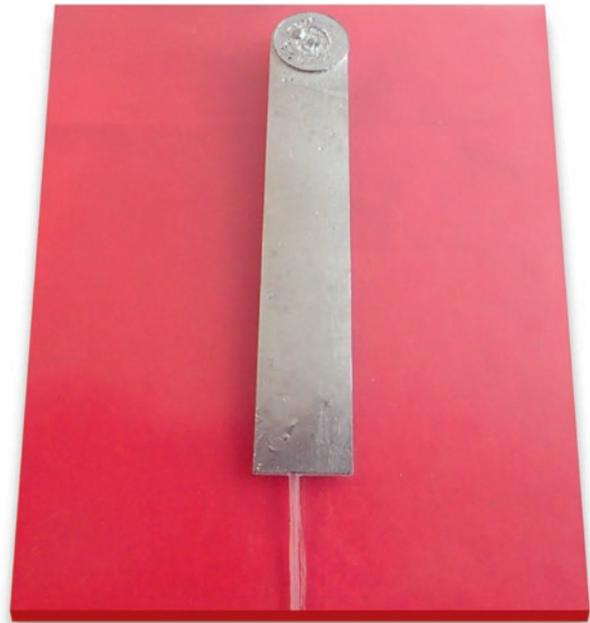
Abbildung 1: Probekörper mit 42VDI-Erodierstruktur.
