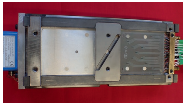
Versuchswerkzeug: linke Kavität mit Referenzsensor, rechte Kavität mit Dünnschichtsensoren
