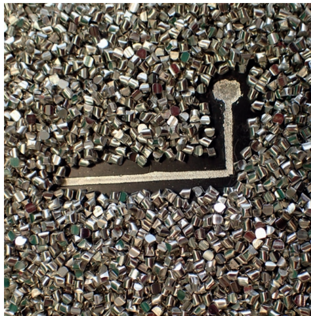
Leiterbahn aus Sn-Cu-Legierung
