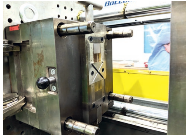
Abmusterung Zirkonoxid beschichteter und hälftig laserstrukturierter Einsätze
