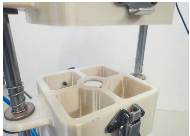
Prototyp des Wärmeleitprüfstandes in der KIMW-F
