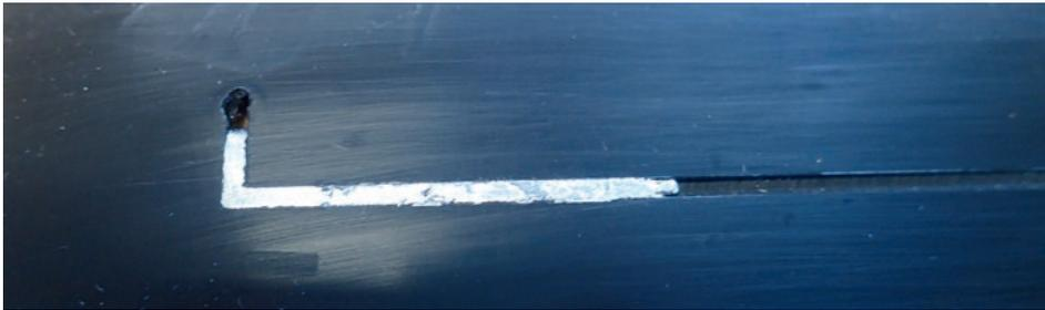
Testplatte - hybrides Testbauteil zur Untersuchung der Haftfestigkeit
