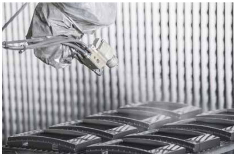
Roboterlackierung mittlerer Losgößen
