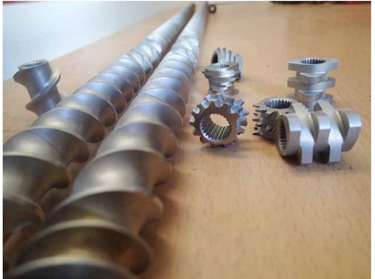
Modular aufbaubare Schnecken mit verschiedenen Elementen
