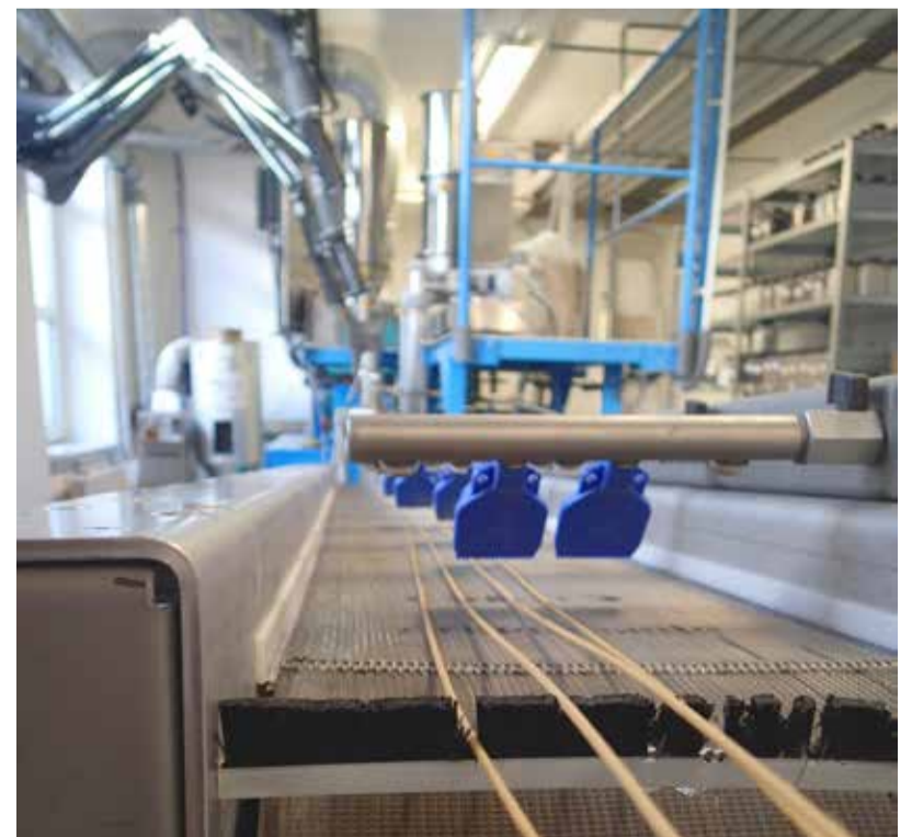
Polymerstrang auf dem Bandförderer vor Granulator
