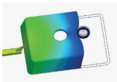
Rheologische Simulation des RFID-Demonstrator Werkzeuges (links), Demonstratorbauteil mit RFID Tag (rechts)
