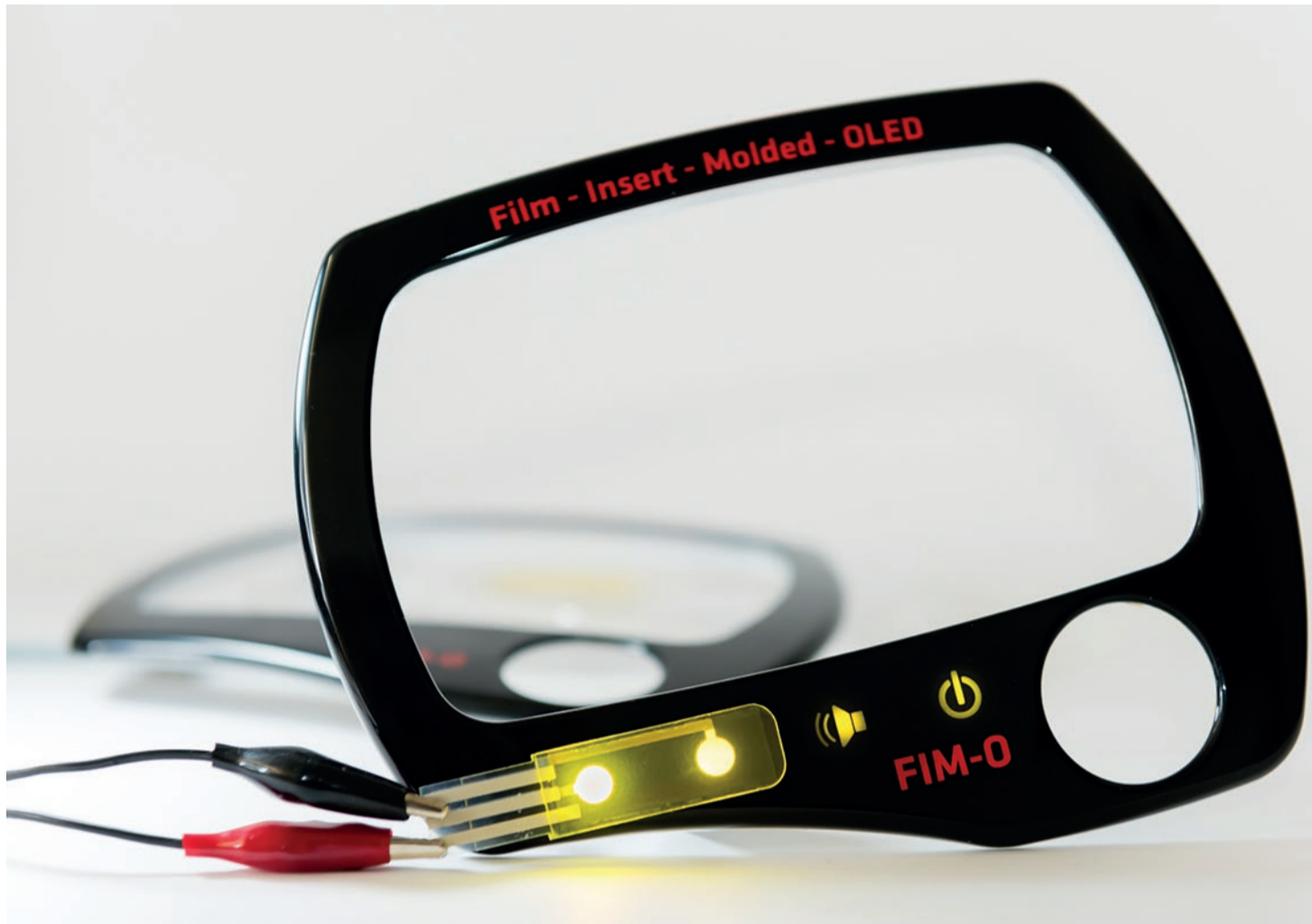
Abbildung 2: OLED-Einleger mit sechs Millimeter großen Leuchtpunkten
