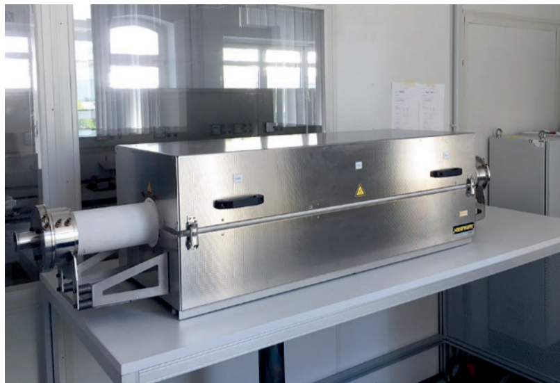
Neu angeschafft und schon im Forschungseinsatz im Dienst der Kunden: CVD-Anlage
