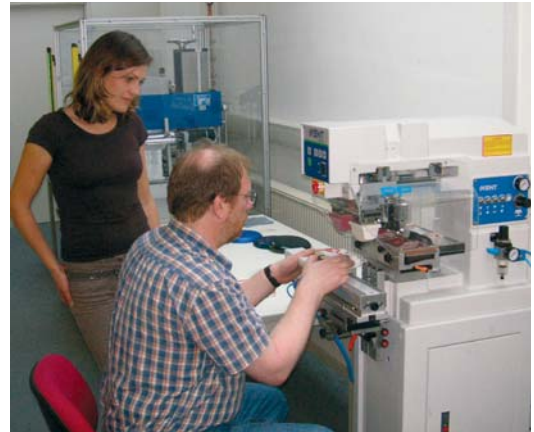
Neue Möglichkeiten im Kunststoff-Institut: Heißprägen und Tampondruck.
